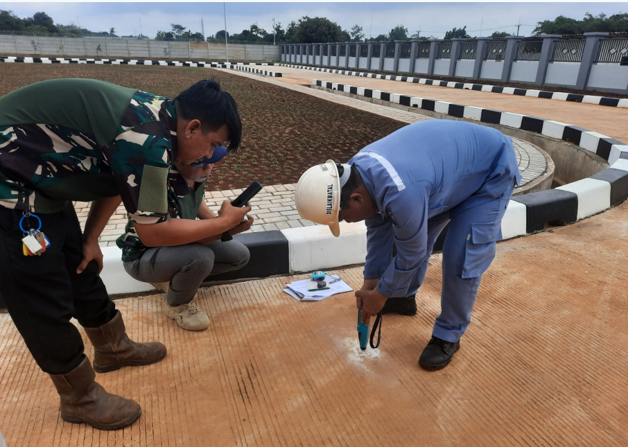
Pengujian kekerasan beton pada konstruksi jalan
